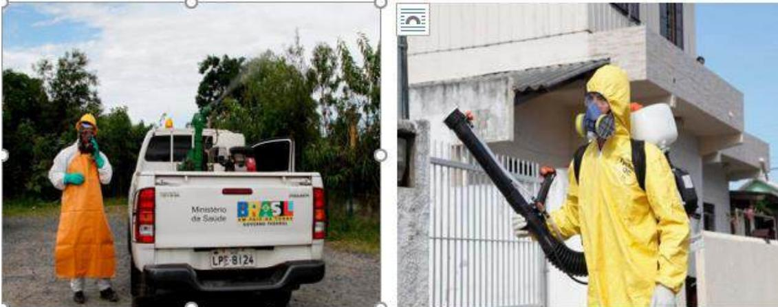
Figura: Equipamento UBV acoplado a veículo e costal motorizada
