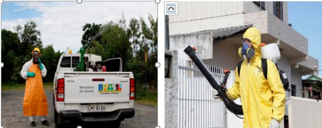
Figura: Equipamento UBV acoplado a veículo e costal motorizada
