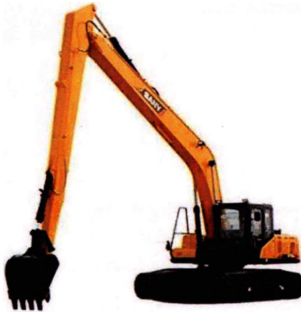
Figura 6: Escavadeira Hidráulica sobre Esteira Long Reach (imagem ilustrativa)
